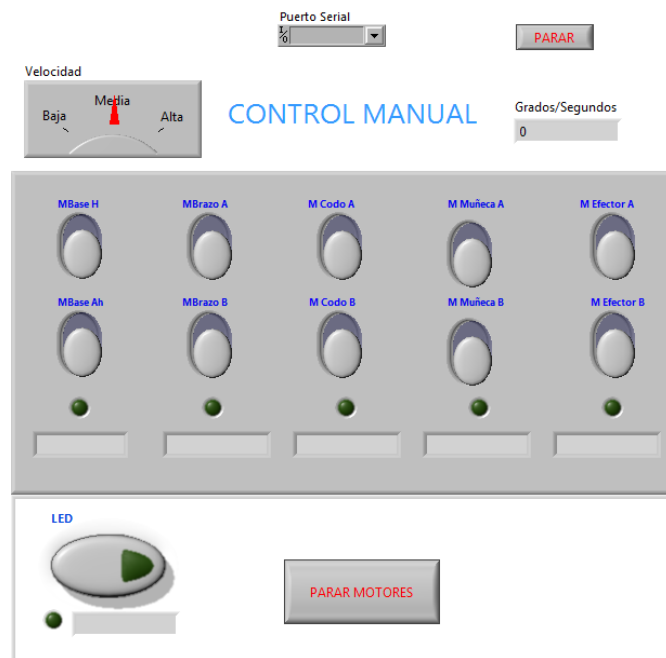
Fig.6. Panel Frontal del Control Manual del Brazo Robótico.
