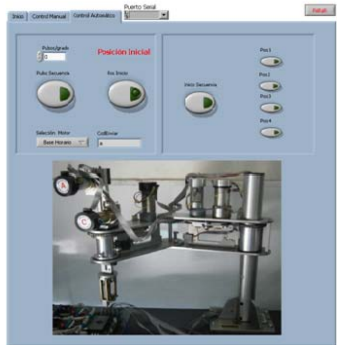
Fig. 7. Panel Frontal del Control Automático del Brazo Robótico
